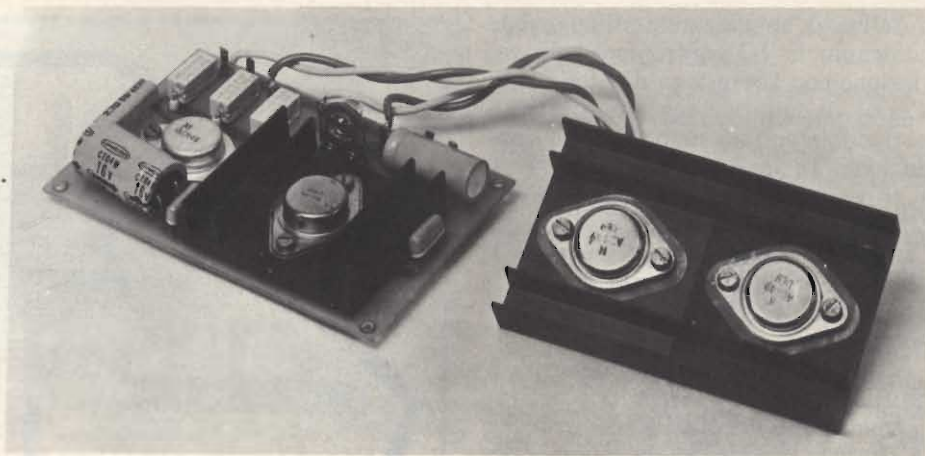
Fig. 11 - Prototipo dell'alimentatore di figura 8 a realizzazione ultimata.
